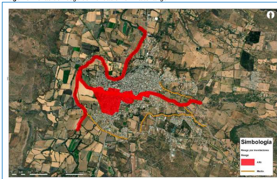
Imagen 5. Zonas de riesgo de inundación en Tlaltenango
